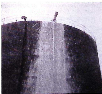
Bild 4. Begjutningshuvud för montering på cisternmantelns insida. Bilden visar ett provningsarrangemang. Observera det samlade skumutflödet.
